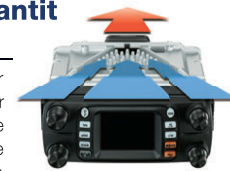
FACC: Conducteur à convection d'air à buse (soufflerie)
