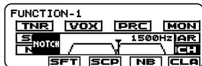
IFノッチ回路とは、図(A)に示すように、フィルターの帯域内に深く鋭い切れ込み(ノッチ)を作り、不要なビート音を減衰させようというものです。
