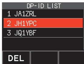
2. DIALツマミをまわして削除するトランシーバーのコールサインを選択して、[DEL]にタッチします。
