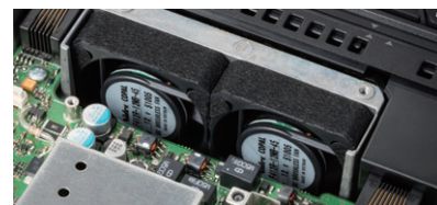
Doubles ventilateurs internes à commande thermostatique
