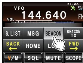
画面右上に「」のアイコンが表示され、SmartBeaconing™ による自動送信が開始されます。
