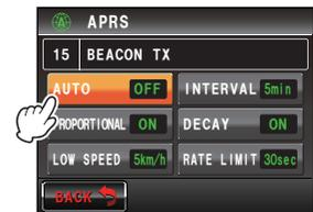
SMART：SmartBeaconing™ 機能による自動送信を行います。セットアップメニューの**[APRS]** → **[30 SmartBeaconing]** の STATUS 設定を TYPE1 ~ TYPE3 に設定し、さらに **[26 MY POSITION SET]** を GPS に設定している場合だけ、この設定を選択できます。
